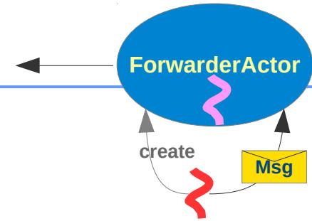
Dieser Aktor leitet die Nachrichten des Threads an den entfernten Aktor weiter. Die Tatsache, dass die Nachricht an einen entfernten Aktor geht, ist auch hier völlig irrelevant.
